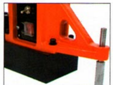
Parafuso de ajuste para manter o equipamento equilibrado
